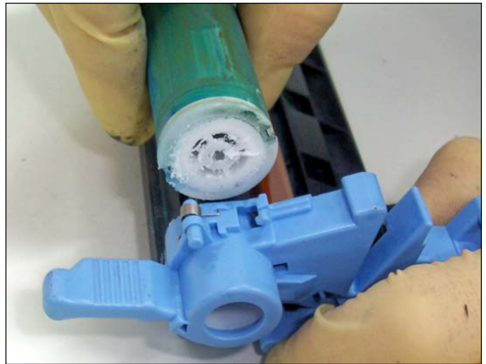
20. OPC spindle shown cut.
